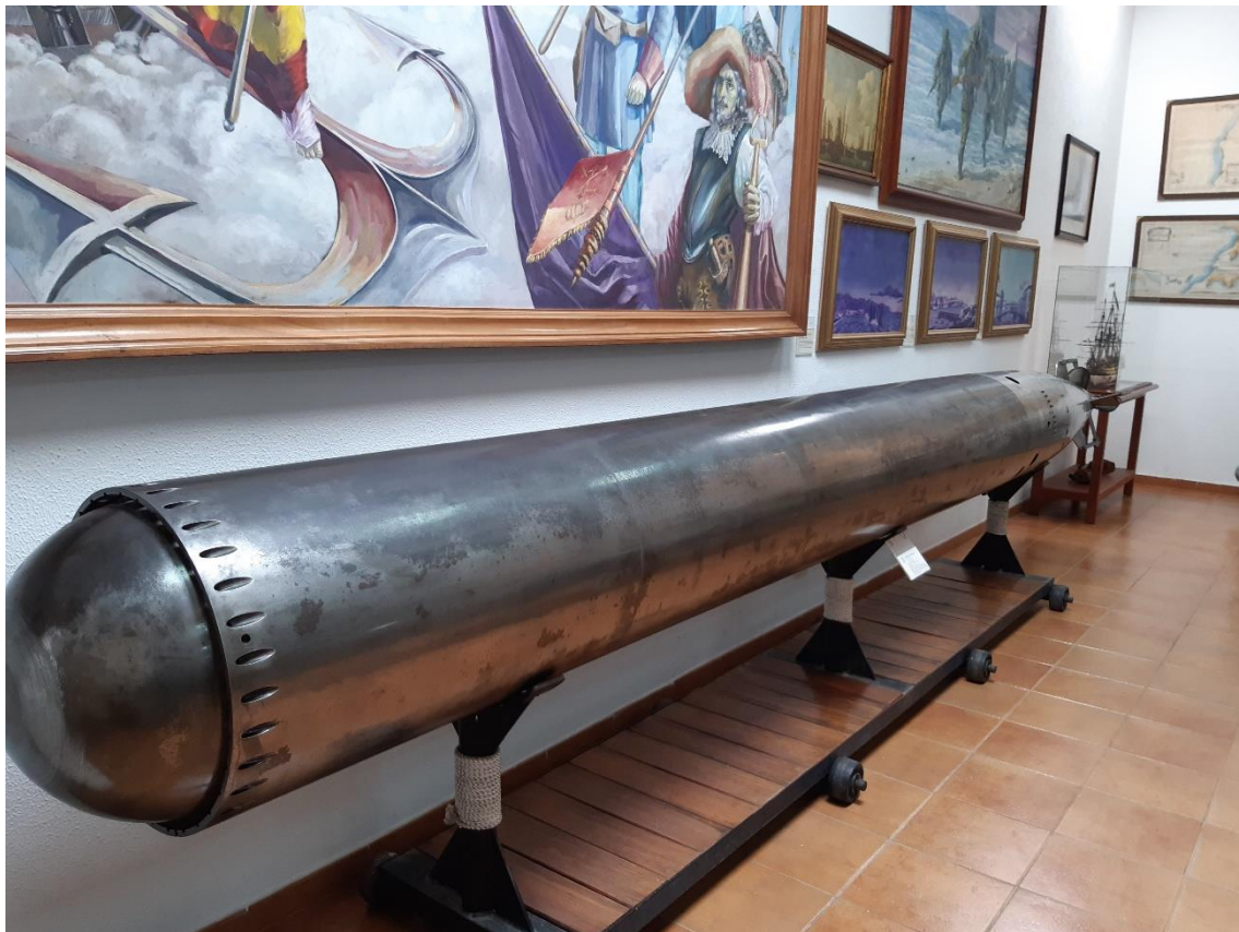
Anexo 1.10: Torpedo G7 A (1538 kg), velocidad de 45 nudos (82kmm). Durante la II Guerra Mundial el submarino alemán U-81, hundió con un torpedo de este tipo de un impacto al portaviones HMS Ark Royal, considerada uno de los buques más importantes de la Royal Navy (fotografía propia). Fuente: Museo Naval de Las Palmas.
