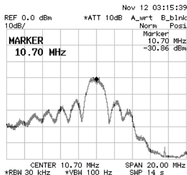
Fig. 10. DEP de la salida del filtro de frecuencia intermedia en la rama detectora de los ceros (rx).
