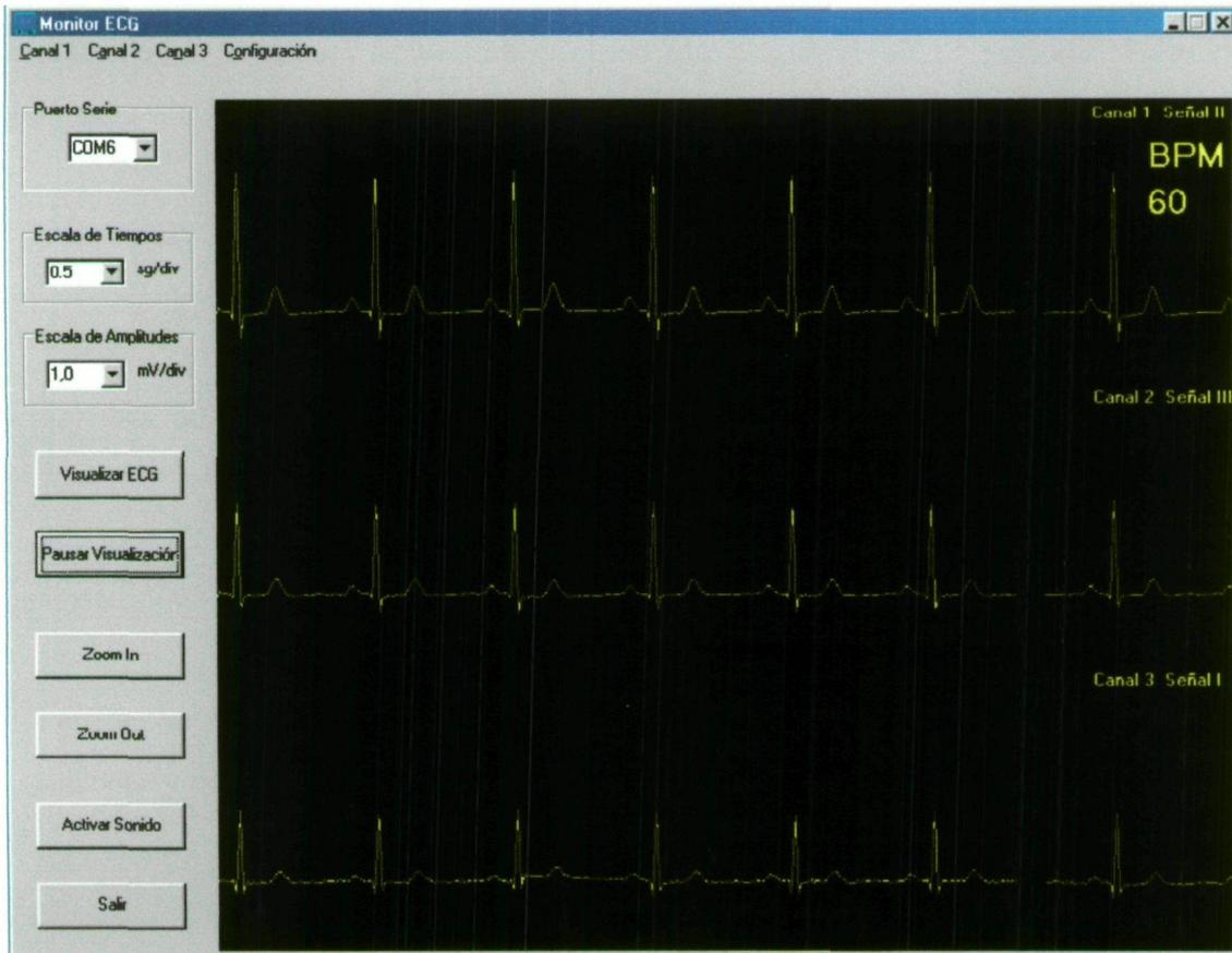
Figura 6.3 Interfaz de usuario de la aplicación de visualización ECG.
