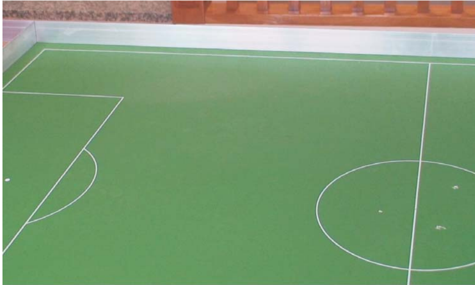
Figura 7.1: Un fotograma de un escenario típico de aplicación. Las primitivas que se usan para calibrar son las líneas blancas y los círculos detectados en la imagen.
