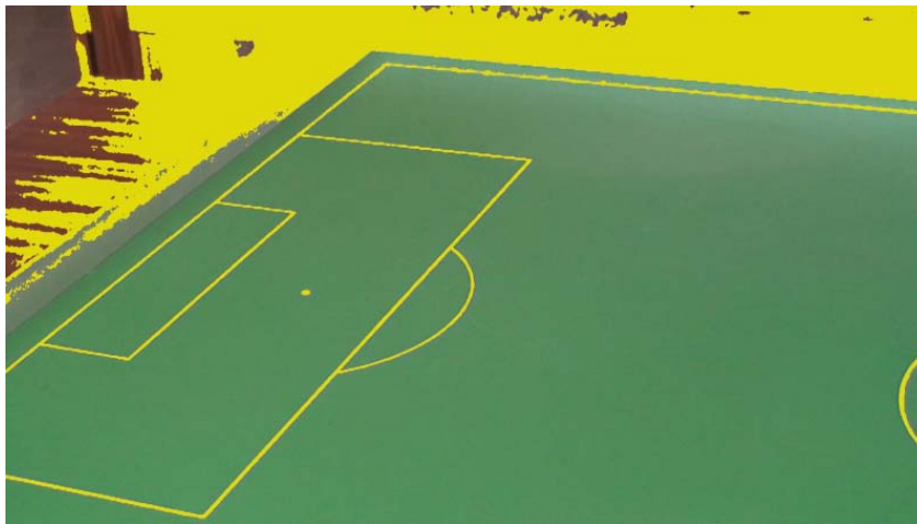
Figura 5.10: Imagen del modelo a escala segmentada con el método CART . Los puntos clasificados como primitiva se han destacado en amarillo. Los vídeos completos se pueden encontrar en http://www.ctim.es/demo105/
