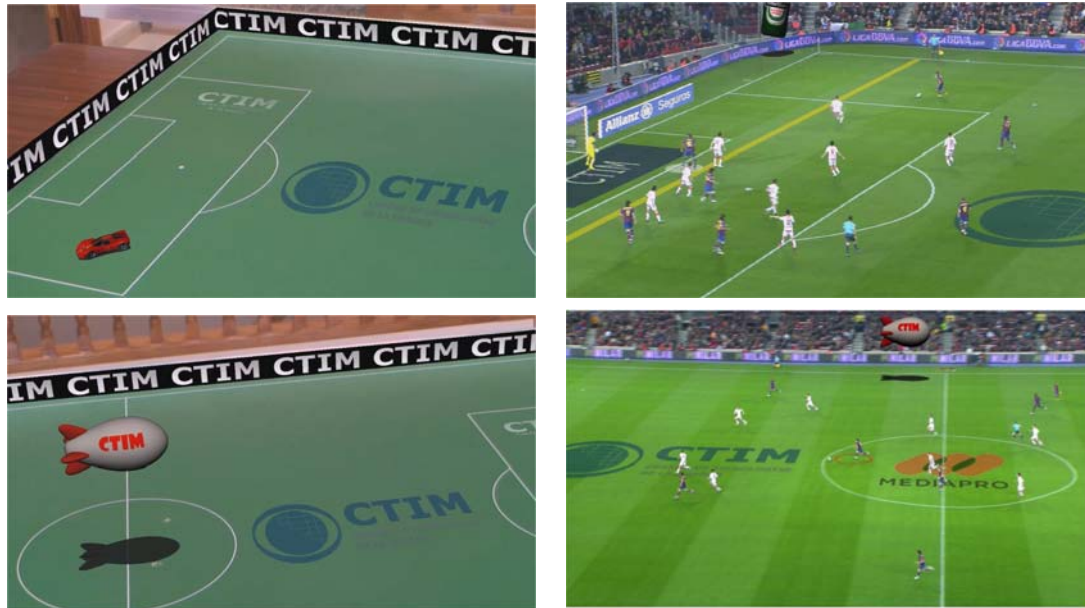
Figura 8.5: Inserción de gráficos con calibración de cámaras usando la geometría del trípode y seguimiento de primitivas. Extraída de los videos proporcionados como material suplementario ( http://www.ctim.es/demo104/ ).
