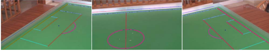
Figura 4.2: Geometría de la calibración del trípode para tres fotogramas de referencia. Para validar los resultados, las primitivas del campo de fútbol han sido proyectadas en las imágenes reales usando diferentes colores.
