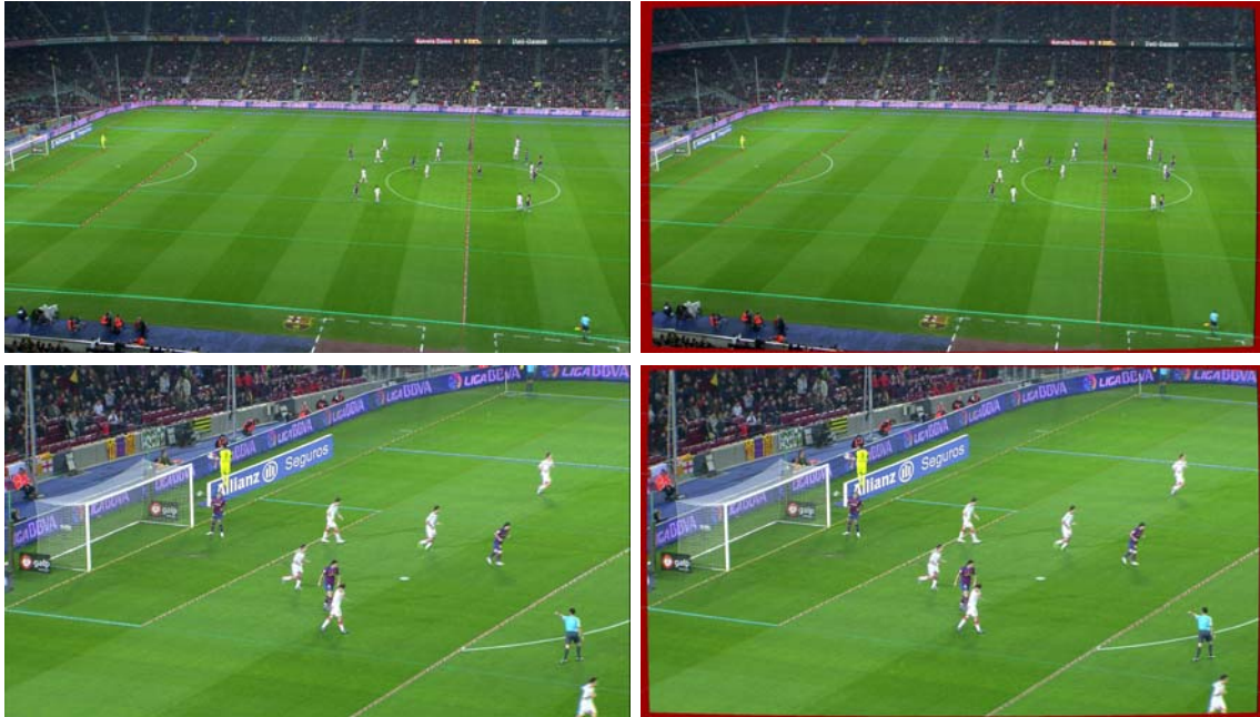
Figura 6.6: A la izquierda, las primitivas usadas en el experimento para la secuencia de vídeo de fútbol: arriba ( f = 45.16 mm.), y abajo ( f = 156.55 mm.). A la derecha, imágenes y primitivas con la distorsión eliminada aplicando el modelo del zoom propuesto. Se puede apreciar la variación de los modelos de distorsión con respecto a f , mirando la curvatura de los límites de la imagen: en el caso de f = 156.55 mm., la corrección de la distorsión de lente es significativamente más pequeña que en el caso de f = 45.16 mm.
