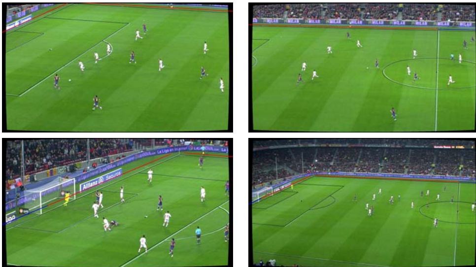
Figura 4.4: Resultados de la calibración de la cámara. Imágenes de partidos de fútbol reales: A la izquierda seguimiento de líneas. A la derecha se muestran las imágenes donde se ha proyectado el campo de fútbol de referencia usando los parámetros de la cámara calculados.
