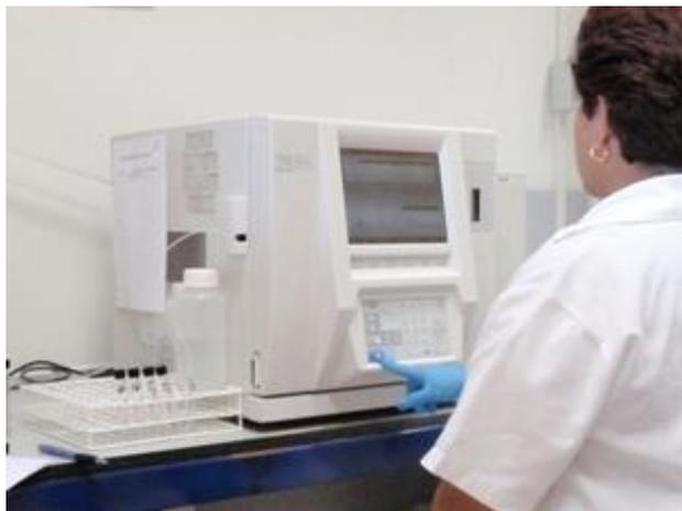
**Figura 2. 5: Analizador TOC Shimadzu, modelo VCSH**
