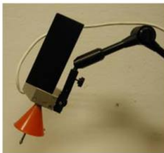
Figura 8.20. Muestra del sensor de deformación con un separador incorporado. Adaptado de Simunic, (2003).
