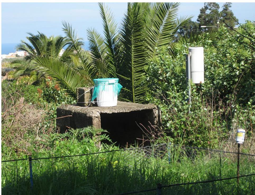
**Figura 2.** Captador del agua de lluvia en uno de los puntos de muestreo.
