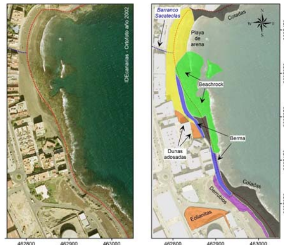
Figura 3. Esquema geológico interpretativo de la playa urbana de Salinetas, donde se aprecia el depósito de beachrock junto con otras formaciones geológicas y depósitos antrópicos.
