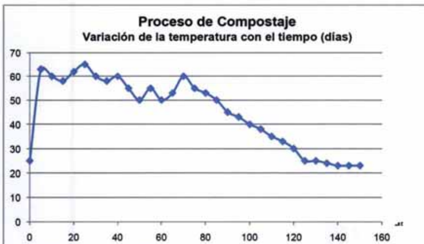
Figura 3: Gráfica mostrando la evolución de la temperatura en una pila de compost.
