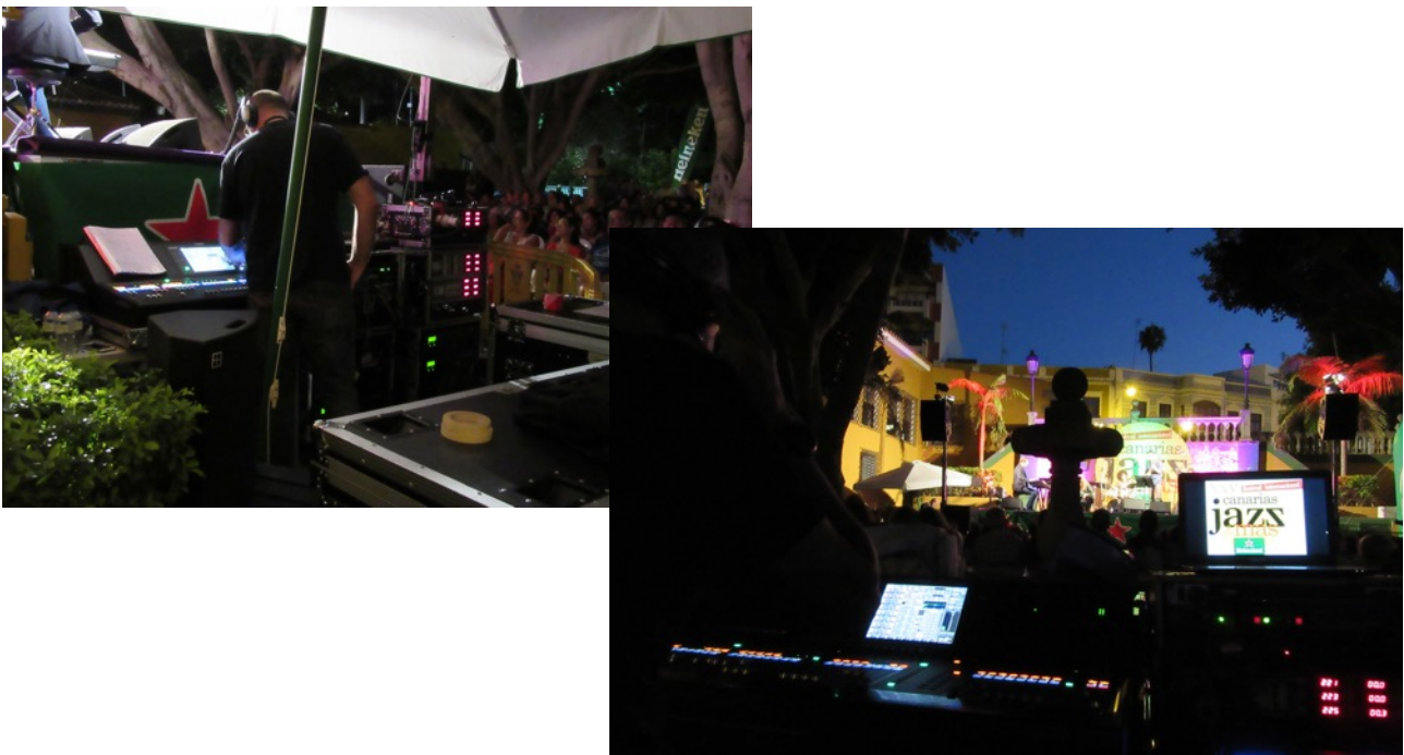
Fig. 5.5- Instantáneas tomadas desde la posición de control de monitores y control de PA respectivamente durante el desarrollo de uno de los conciertos en Santa Brígida. En ambas imágenes (derecha de cada imagen) se pueden ver los indicadores de los cuadros de corriente (lectura de tensión y corriente por cada fase).
