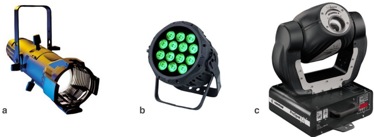
Fig. 3.4- Ejemplos de proyectores similares a los que se utilizaron en el Festival de Jazz. Según aparecen: (a) Recorte convencional; (b) Foco PAR LED; (c) Móvil tipo Spot. Se han ordenado por orden de complejidad (de más simple a más complejo) en cuanto a posibilidades y uso de canales DMX. Además, las lámparas que albergan en su interior usan tecnologías distintas. Por orden: (a) Lámpara de incandescencia, (b) Tecnología LED, (c) Lámpara de descarga HMI.
