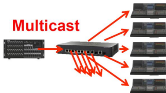
Fig. 2.47- Ejemplo de tráfico multicast [18].
