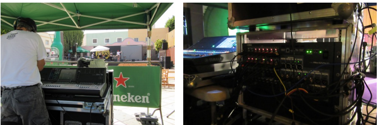
Fig. 2.51- Puestos de control de PA y control de monitores en la Plaza de San Rafael, Vecindario.
