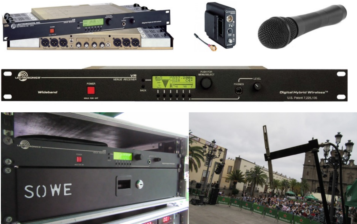
Fig. 2.81- Sistemas de microfonía inalámbrica Lectrosonics, utilizados en el Festival de Jazz. Fueron instaladas dos antenas (sistema Diversity), de tipo dipolo
