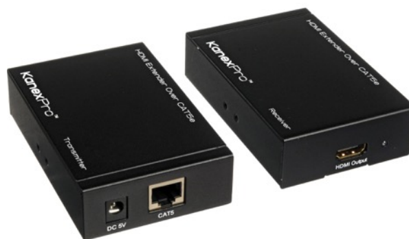
Fig. 4.2- Conversores de HDMI a HDMI over Ethernet con puerto RJ45 y cable UTP CAT 5e o CAT6, para poder hacer uso de mayores distancias entre fuente de señal y vídeo-proyector. Se aprecia el transmisor y el receptor.
