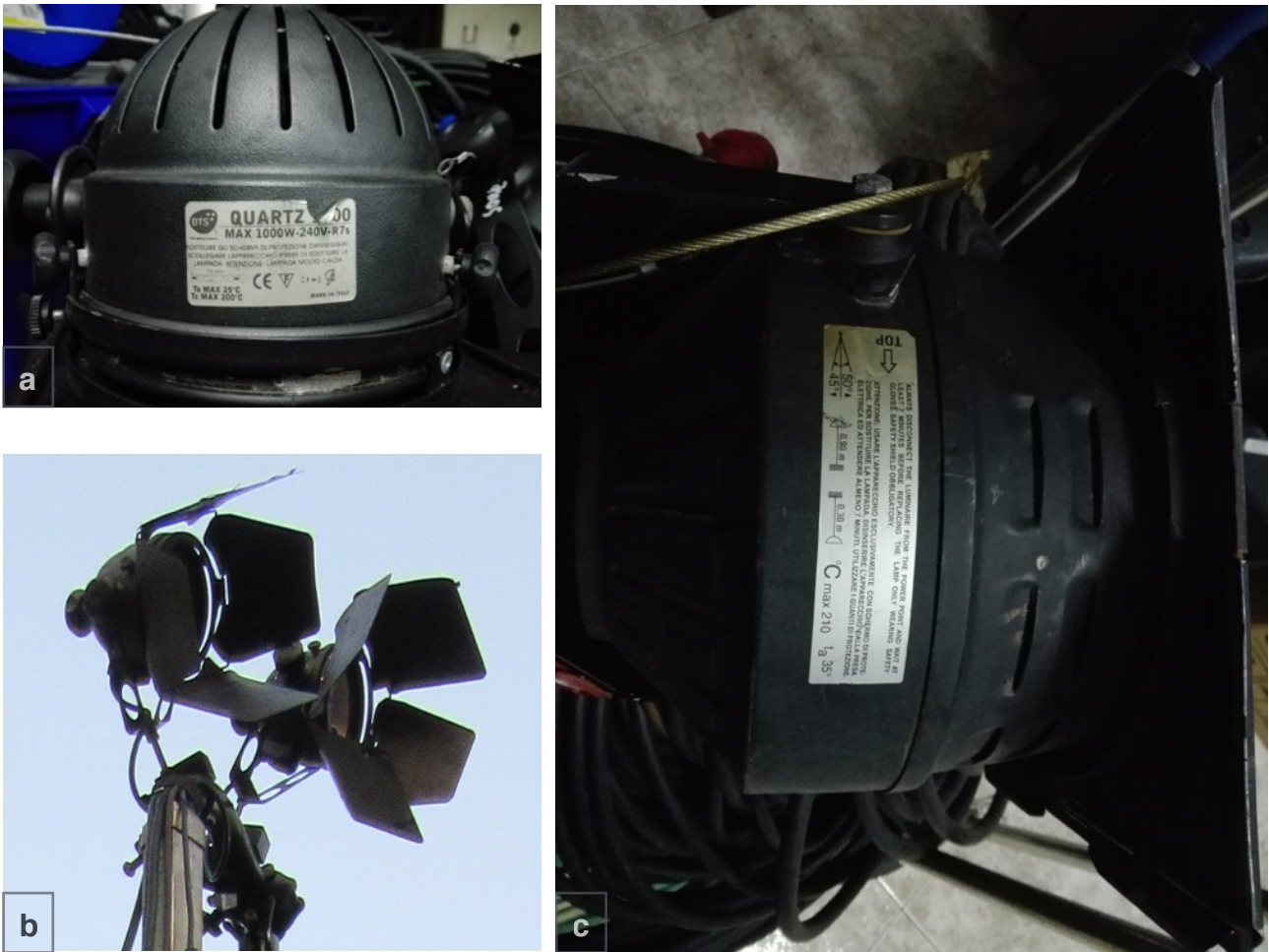
Fig. 3.9- Proyectores de luz de incandescencia blanca, DTS 1000 (a y b) y DTS 2000 (c).
