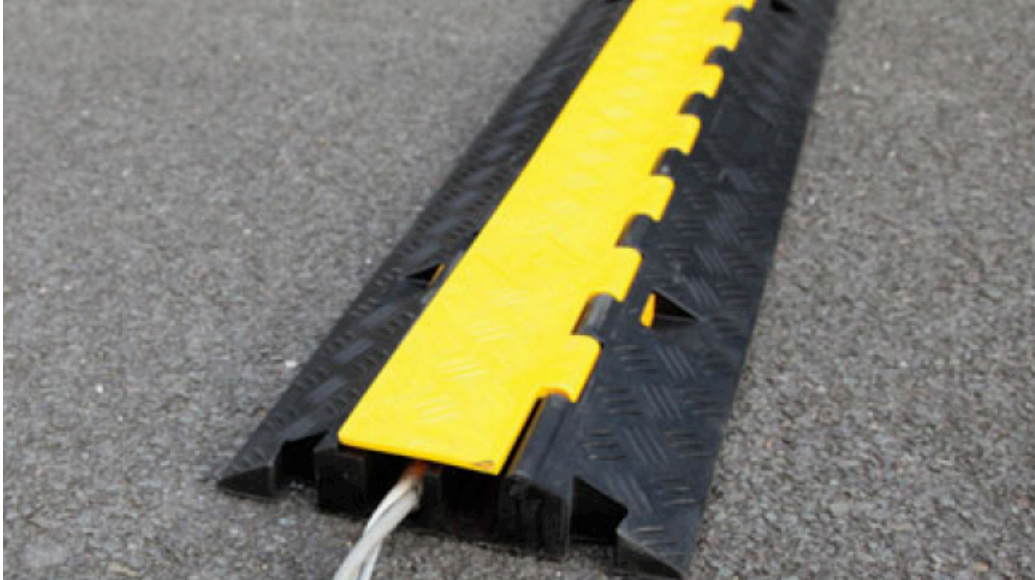
Fig. 5.1- Ejemplo de protección mecánica mediante el uso de pasacables homologados. Se trata de elementos que se deben colocar siempre que se trata de una zona de posible tránsito de personas y/o vehículos.
