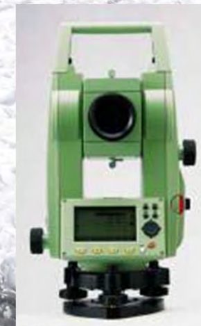
3. Estación total: Leica TCR 207
