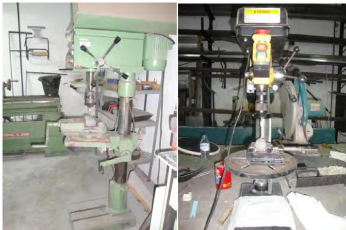
Figura 8. Imágenes de los taladros utilizados para perforar los 200 cantos necesarios para este trabajo de investigación.
