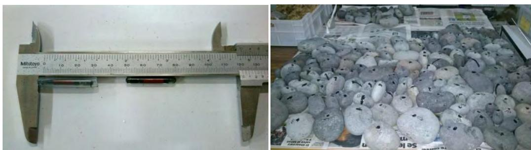
Figura 9. Izquierda: Imagen de los tags, uno dentro de la manguera y el otro no. Derecha: Imagen de algunos de los 200 cantos durante el proceso de secado, una vez introducido el tag y sellado con la resina epoxi.
