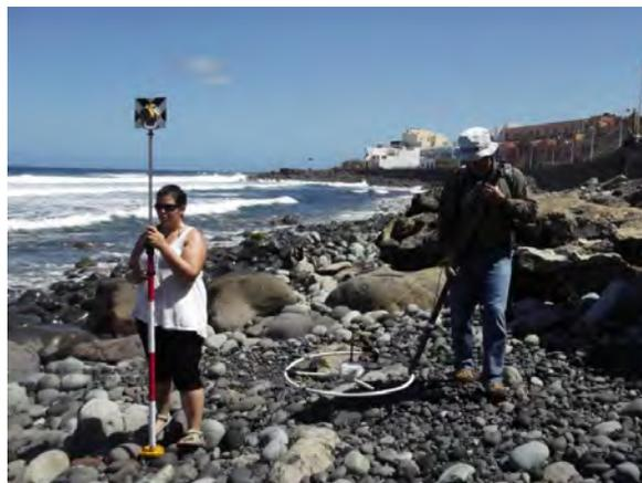
Figura 11. Imagen en la que se puede observar el procedimiento de detección de cantos. Mientras la persona responsable del prisma está posicionando el canto anteriormente detectado, la que lleva la antena sigue buscando el resto de cantos.
