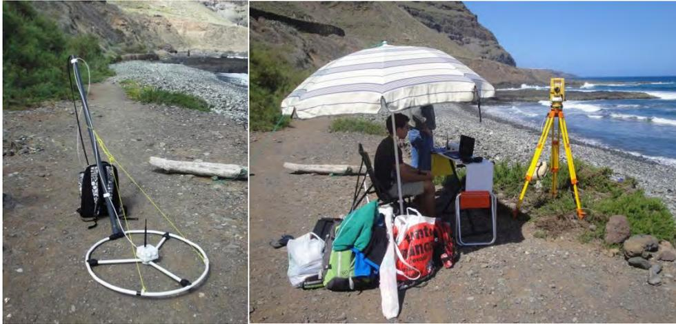
Figura 10. Izquierda: Imagen del sistema de detección. Derecha: Punto base donde se reciben los datos del sistema de detección y se posicionan con la estación total.
