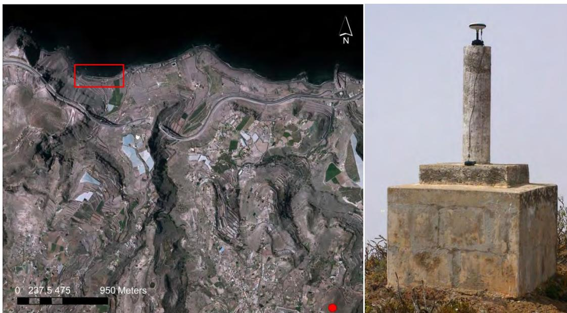
*Figura 12. Izquierda: Localización del vértice geodésico empleado para la obtención de las coordenadas del clavo de la playa de San Felipe. El punto rojo (parte inferior derecha de la imagen) corresponde a la situación exacta del vértice, y el recuadro rojo indica la playa de San Felipe. Derecha: Imagen del vértice geodésico Gallego con la antena del DGPS en el momento de la obtención de las coordenadas del clavo.*
