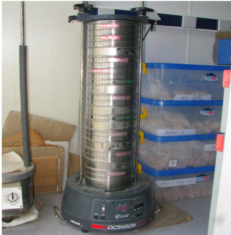
**Figura 2.** Tamizadora Octagon Digital con columna de 16 tamices (laboratorio de geología ULPGC).
