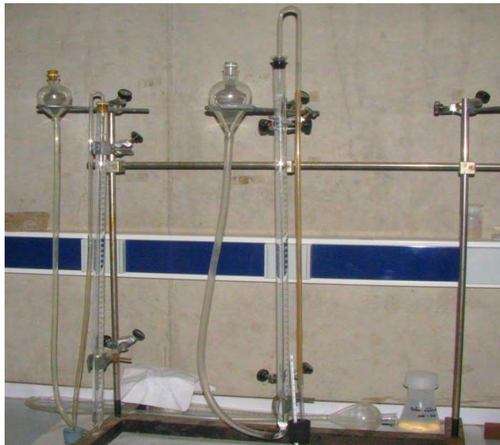
**Figura 3.** Calcímetro de Bernard utilizado para medir contenido en carbonatos (laboratorio de geología, ULPGC)
