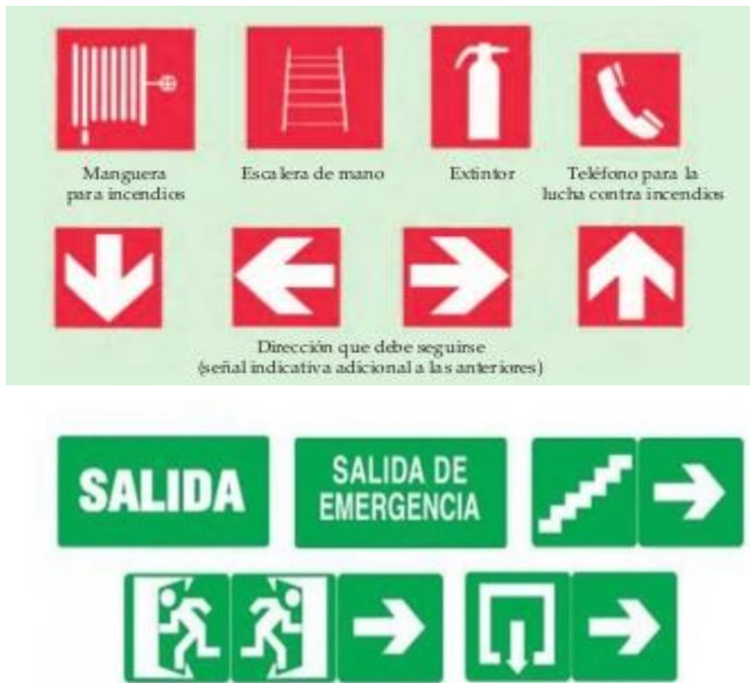
Ilustración 5. Señales indicativas de evacuación ubicadas en el centro escolar. (Pascual Lizana, C. (2009), Guía técnica sobre Señalización de Seguridad y Salud en el Trabajo . Recuperado de: https://es.slideshare.net/CECY50/sealizacin-30770805 ).
