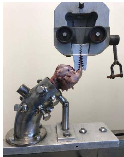
Figura 2: Montaje experimental de la tibia operada de TTA.
