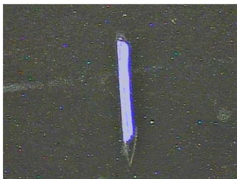
Figura 2: Defecto realizado en la probeta pintada dejando al descubierto el metal base (acero al carbono).
