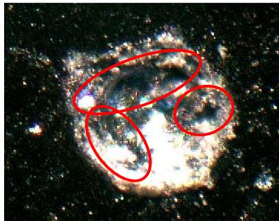
Figura 12: Fotografía del defecto aplicado al polímero inmerso en una disolución de sulfato de sodio 0.1 M donde se aprecian restos de polímero en el fondo del mismo en los instantes iniciales de inmersión.
