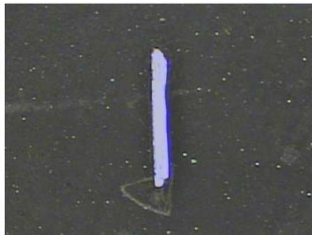
Figura 3: Foto del defecto generado donde se aprecia el metal desnudo en el fondo del mismo antes de ser sumergido en la disolución de ensayo.
