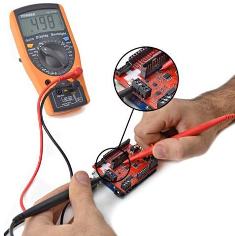
**Figura 2. 16 Medida voltaje correspondiente al sensor GSR**
