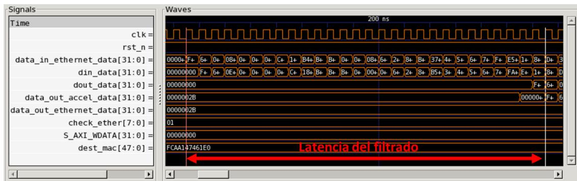
Figura 37: Co-simulación *Header Analyzer*. Latencia del filtrado
