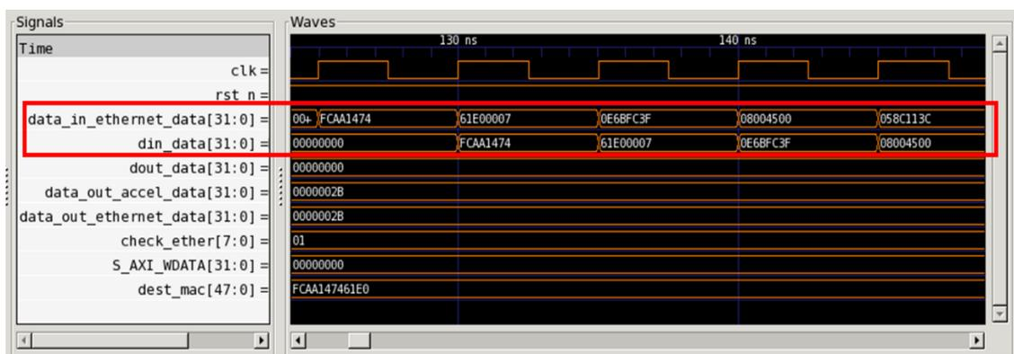
Figura 33: Co-simulación *Header Analyzer*. Recepción del paquete
