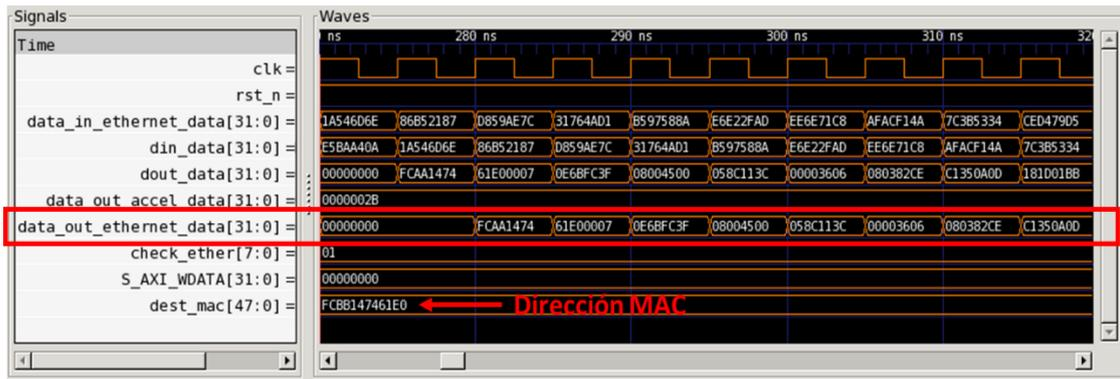
Figura 36: Co-simulación *Header Analyzer*. Redireccionamiento del paquete a la red
