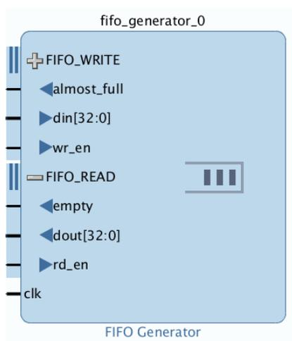
Figura 59: Bloque IP FIFO
