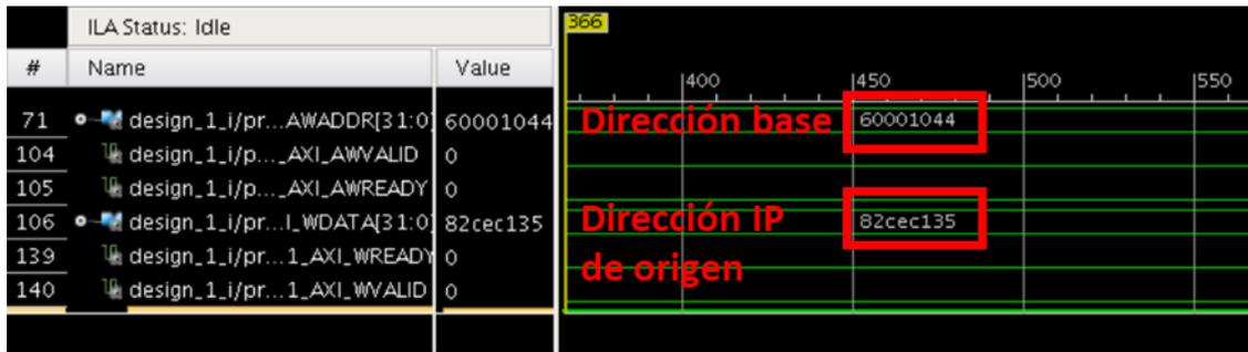
Figura 87: Validación de la configuración del *Header Analyzer*
