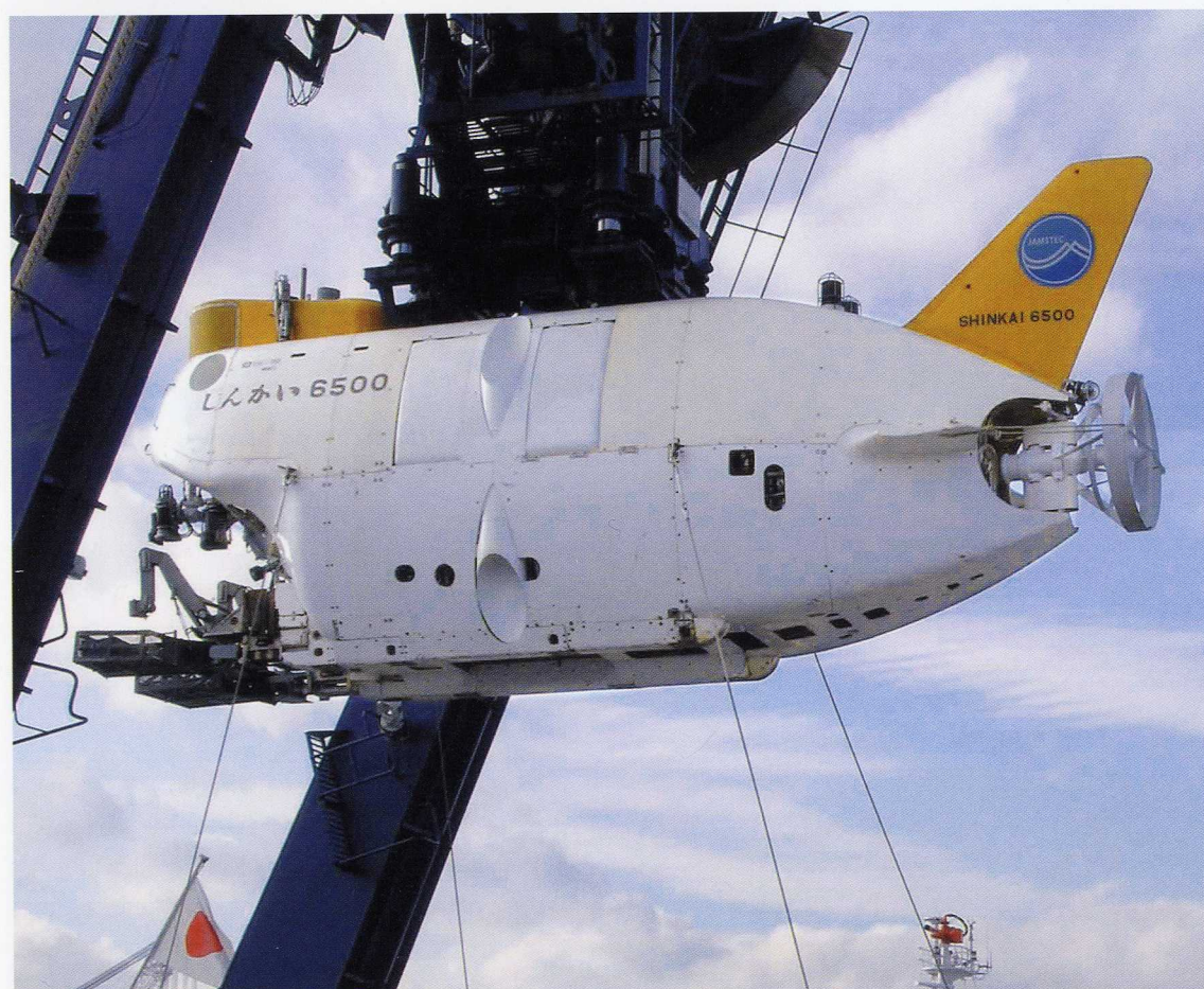
◀ Dos sumergibles oceanográficos, el Johnson Sea-Link II de la Harbor Branch Institution y el Shinkai 6500 del JAMSTEC que puede descender a 6.500 metros, de ahí su nombre.
