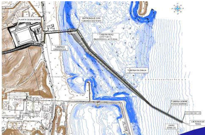
Figura A1.2. Nuevo consumo de agua de mar (HDPE de 2000 mm, 1051 m de largo, -38 m de profundidad)
