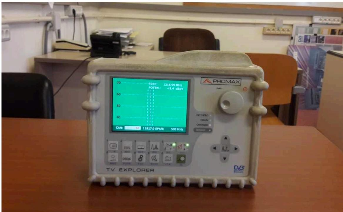
Figura 13. Analizador de espectros portátil (Laboratorio 220, Pabellón B -EITE).
