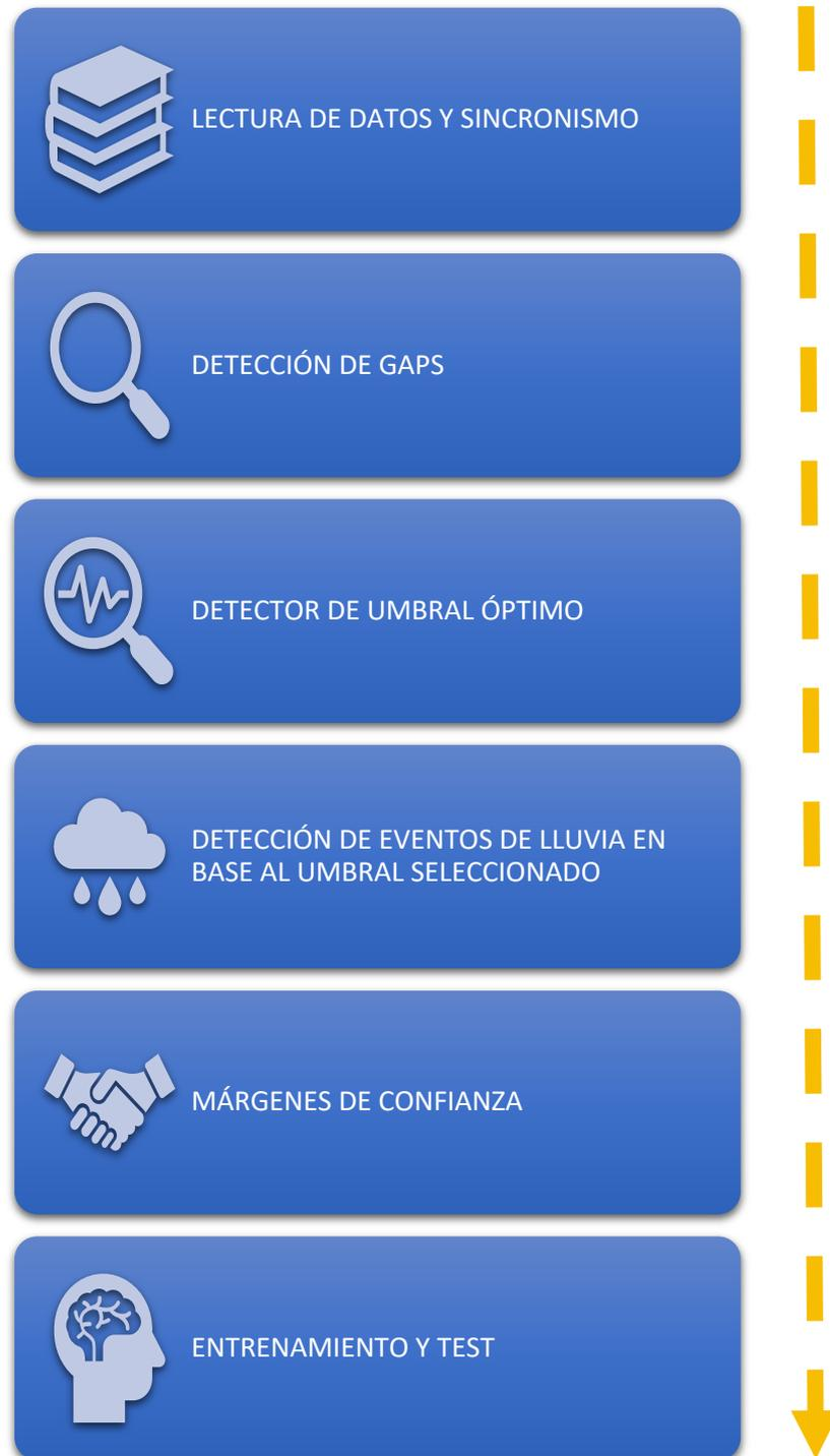
*Figura 40. Diagrama de flujo del algoritmo de detección.*
