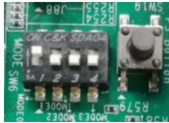
Figura 85: Configuración del switch SW6 para arranque desde la tarjeta SD
