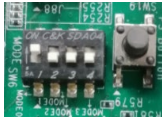
Figura 17: Configuración del switch SW6 para arranque desde la tarjeta SD
