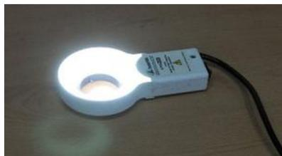
Figura 5.10: Fuente de iluminación blanca basada en tecnología de fluorescente encendida.
