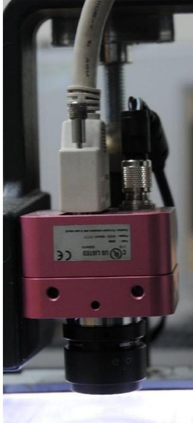
Figura 5.5: Vista transversal de las conexiones de la cámara
