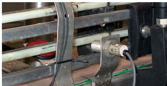
Figura 3.12: Célula fotoeléctrica detectora de latas.
