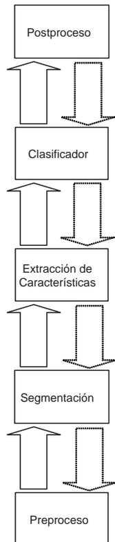
Figura 2.9: Un esquema por fases de un reconocedor/clasificador de formas: Preproceso → Segmentación → Extracción de Características → Clasificador → Postproceso. Sin embargo una fase posterior puede retroalimentar una fase previa para ajustar sus parámetros.
