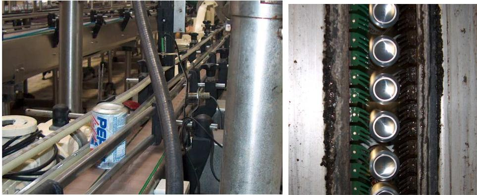
Figura 3.1: Cadena de envasado. Cinta Transportadora. Lata. Código de lata.
