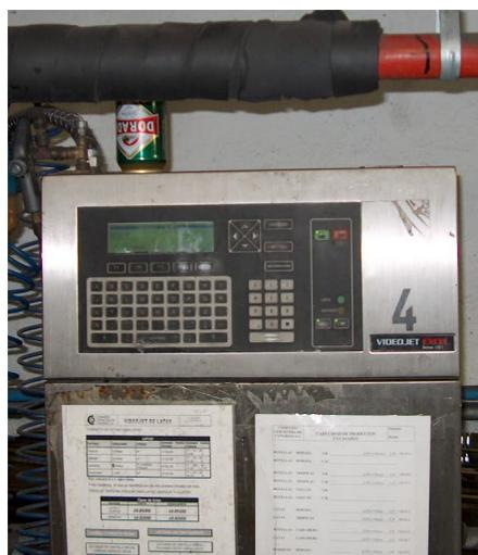
Figura 3.13: Consola de Sistema impresor
