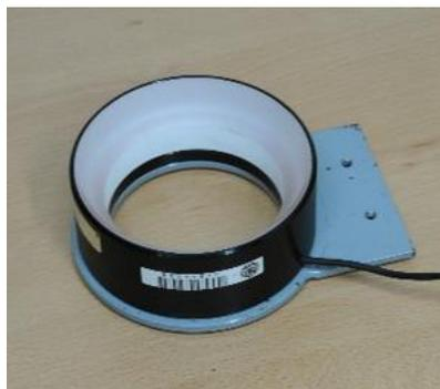
Figura 5.11: Fuente de iluminación roja basada en tecnología LED
