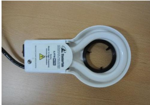
Figura 5.9: Fuente de iluminación blanca basada en tecnología de fluorescente.
