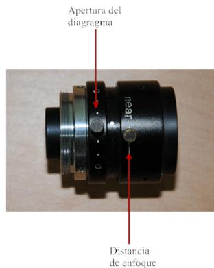
Figura 5.8: Óptica manual utilizada por MONICOD.
