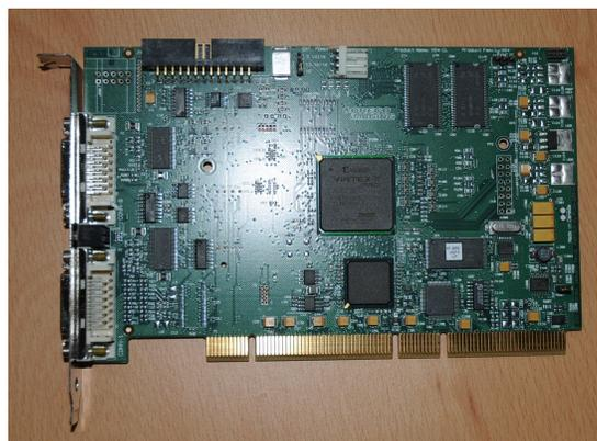
Figura 5.14: Tarjeta de adquisición. X64-iPro
