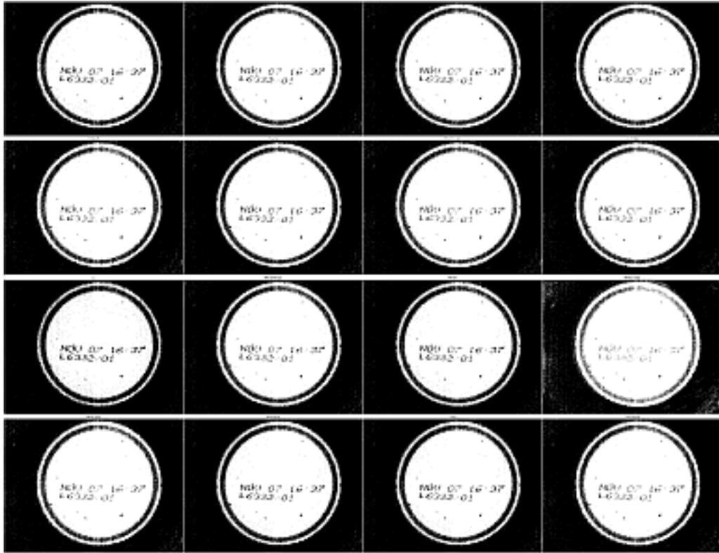
Figura 2.13: Umbrales globales para hojalata. De izquierda a derecha y de arriba a abajo: Variación de IsoData, Huang, Intermodos, IsoData, Li, MaxEntropy, Mean, MinError(variación iterativa del método de Kittler-Illingworth), Minimum, Moments, Otsu, Percentile, RenyiEntropy, Shanbhaqm, Triangle y Yen. Imagen generada con ImageJ([60])
