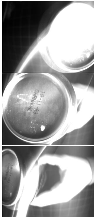
Figura 4.3: Aquí una secuencia de tres imágenes con una configuración de alta velocidad. Se agita la lata tan rápido como es posible y aun así resulta legible la fecha al dorso.
