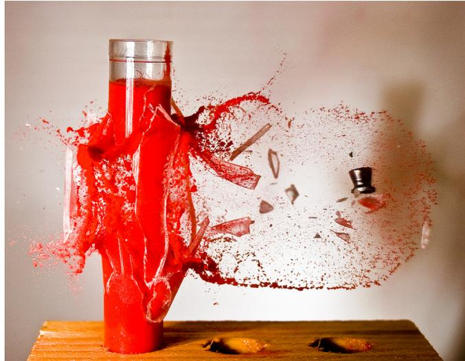
Figura 4.20: Una filmación a alta velocidad permite registrar cientos de *frames* en un soporte de vídeo para un análisis posterior. El registro no suele extenderse más de unos segundos.
