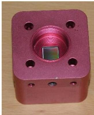
Figura 5.6: Vista del sensor CMOS
