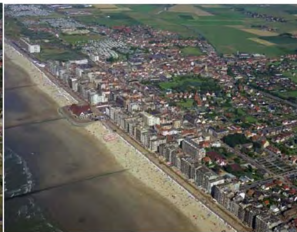
Middelkerke: hoé harde zeeeringen en uitsprongen met een nauw strand resulteren in een onveilige situatie
