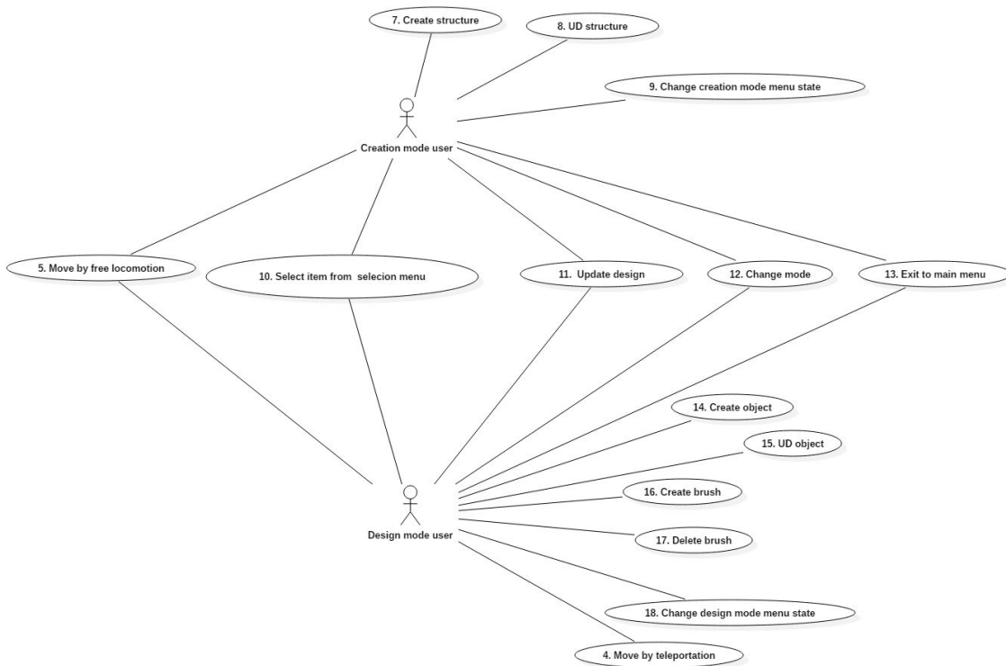
Figura 6.3: Diagrama de casos de uso del Design Mode User y el Creation Mode User.
