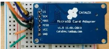
Ilustración 36 – Conexiones adaptador microSD.
