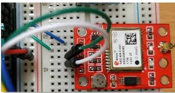
Ilustración 35 – Conexiones GPS.
