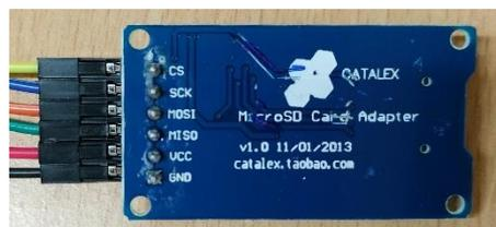
Ilustración 10 – Parte trasera adaptador microSD.
