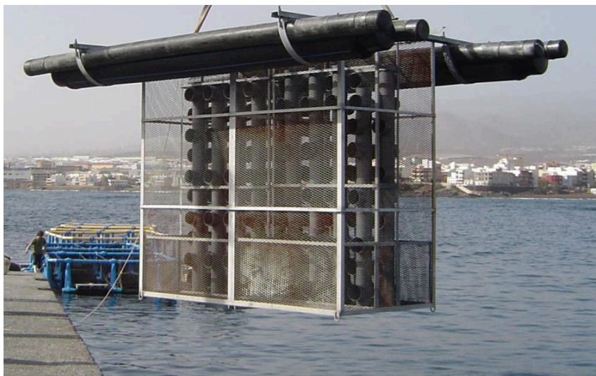
Fig. 4.16: Jaula flotante de 3 \times 3 \times 1,5 \text{ m} , de 10 \text{ m}^3 de volumen útil de cultivo, fondeadas en el muelle de Taliarte (Telde, Las Palmas).
