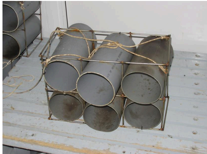
Fig. 4.5: Estructura de 6 tubos de PVC de 160 mm de diámetro, utilizadas a modo de guaridas en los tanques de aclimatación.
