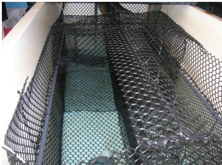
Fig. 4.15: Tanque de compartimentado en 4, con 400 L por compartimento, diseñado para minimizar la interacción entre los pulpos en los experimentos de nutrición.
