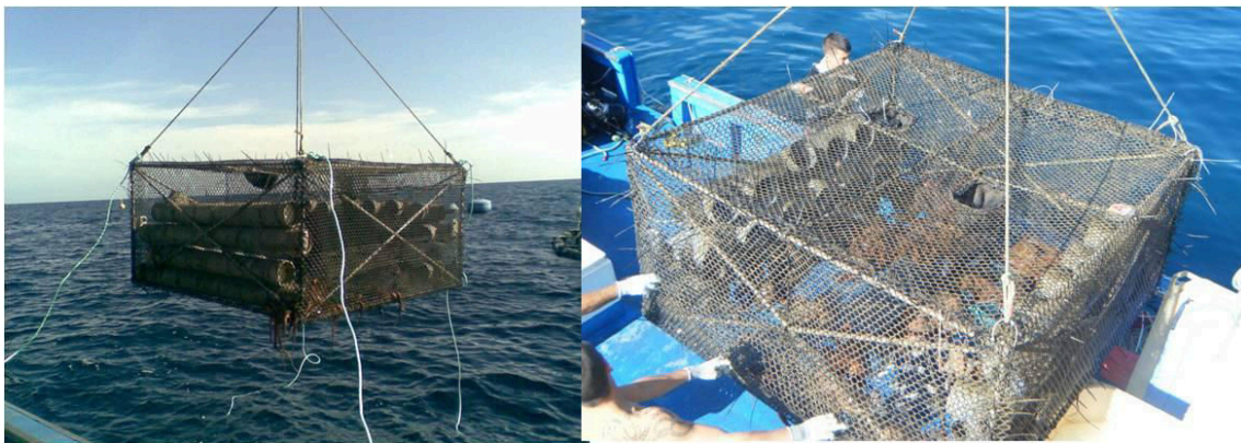
Fig. 4.18: Jaula bentónica de 2x2x1 m, dividida en 2 sub-jaula de 2 m 3 , fondeada a 27 m de profundidad.
